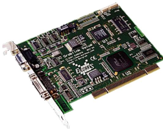
Figure 5 – Carte d'acquisition au format Camera Link
